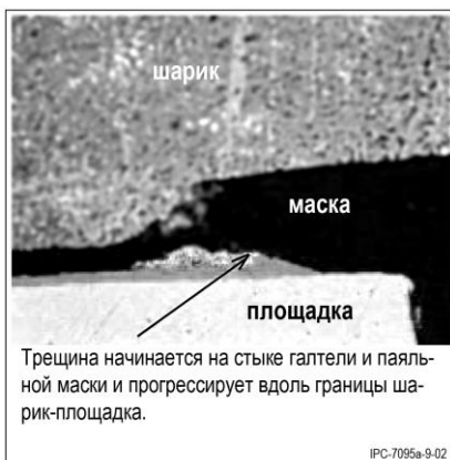
Рис. 3. Форма галтели паяного соединения шарикового вывода с контактной площадкой при различных типах площадок.
